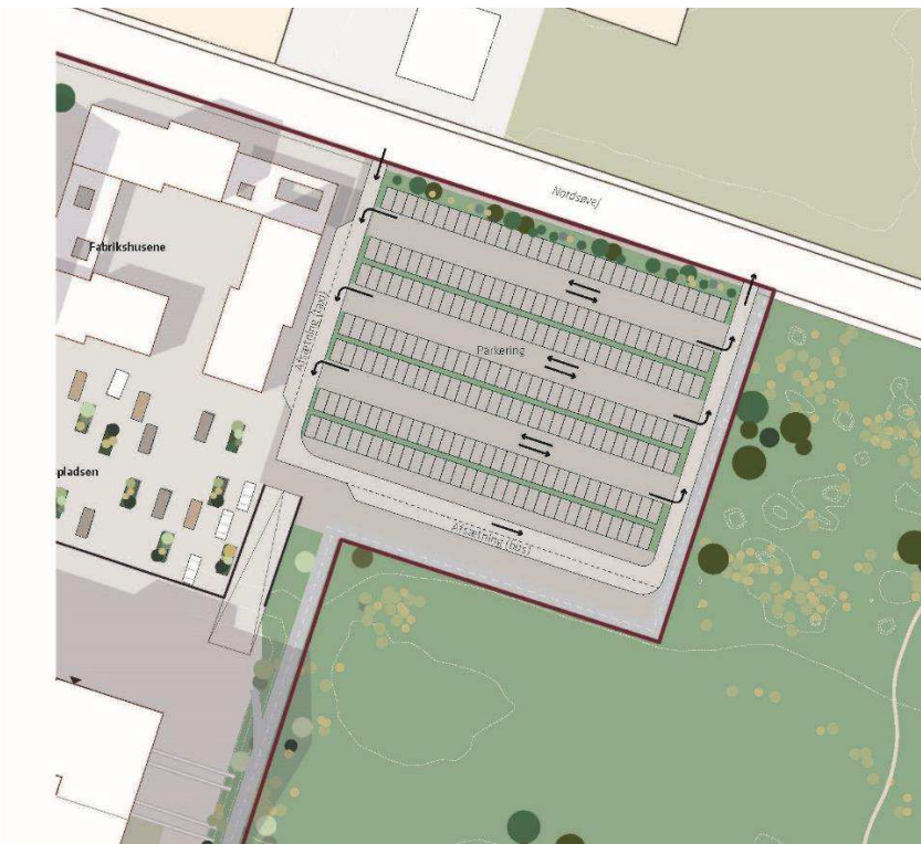
Figur 3 Forslag til parkering på terræn incl. af-/ og påsætningspladser for taxa og busser.
