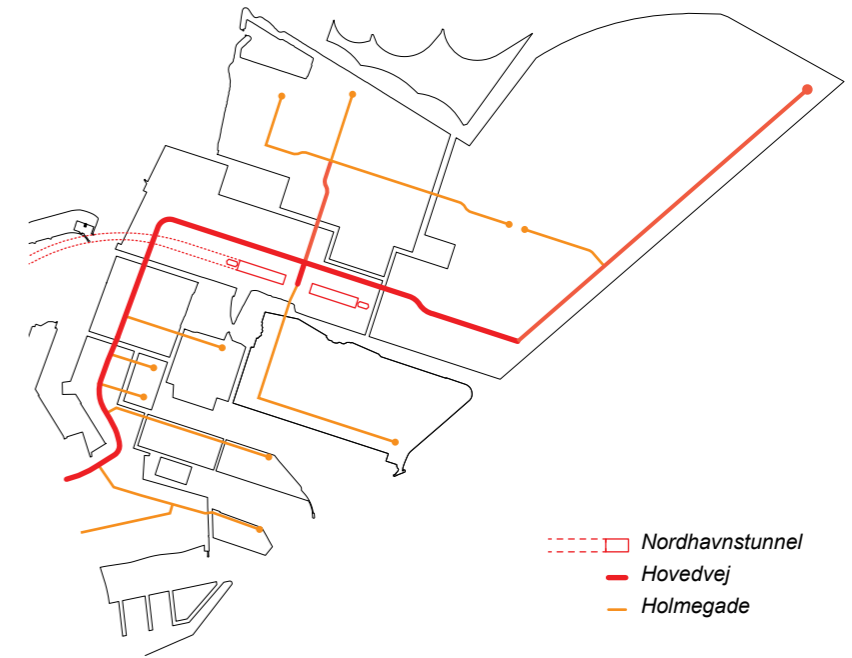
Vejstruktur Nordhavn vejforsynes syd fra af Sundkrogsgade, og vest fra af Nordhavnstunnelen. Sundkrogsgade danner trafikal rygrad, hvorfra mindre "holmegader" fordeler trafikken til de enkelte kvarterer.
