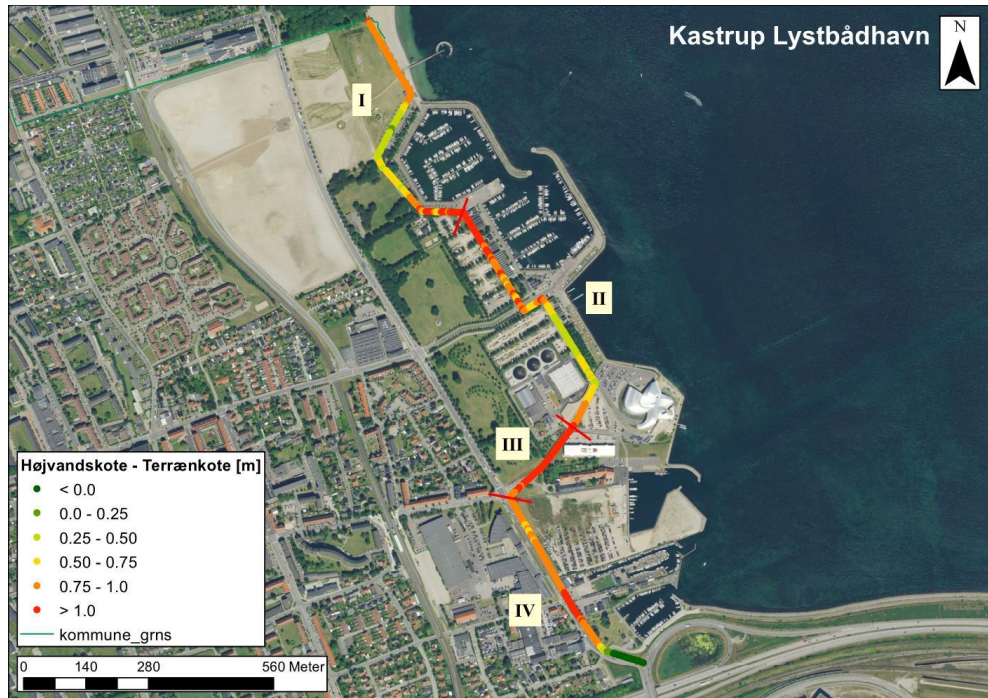
Figur 7-11 Kort for (2,6 m) Kastrup med forskellen mellem dimensionsgivende højvandskoter og eksisterende terrænkoter. Der er her forudsat en stigning i havvandsstand på 100 cm i perioden 1990-2100. Stiger havet 87 cm skal alle digehøjder og koter således reduceres med 13 cm.
