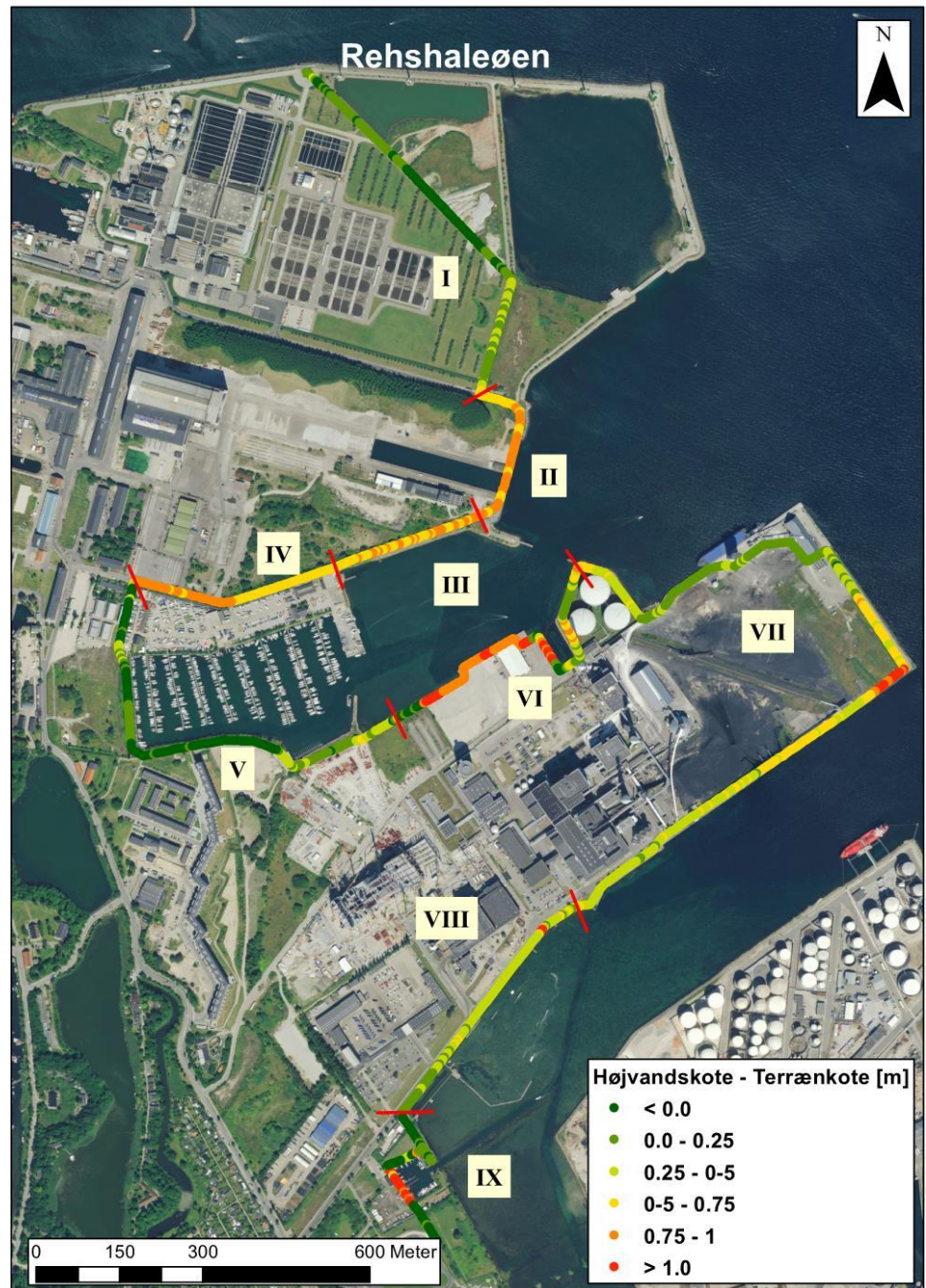
Figur 7-3 Kort for Refshaleøen med forskellen mellem dimensionsgivende højvandskoter (2,7 m) og eksisterende terrænkoter. Der er her forudsat en stigning i havvandsstand på 100 cm i perioden 1990-2100. Stiger havet 87 cm skal alle digehøjder og koter således reduceres med 13 cm.
