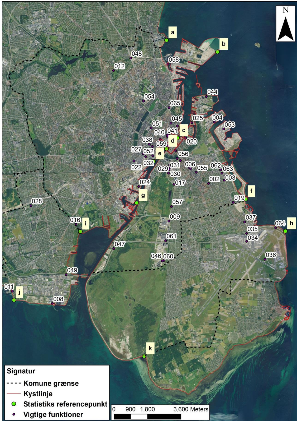
Figur 6-1 Særligt følsomme anlæg oplyst og placeret af Københavns Kommune. Zoom af anlæg i den indre by findes på Figur 6-2. Numrene på tegningen refererer til lokaliteterne i tabellerne Tabel 6-1 og Tabel 6-2. Bogstaverne a-k angiver placeringen af referencepunktet for de kritiske højbvande der er angivet i tabellerne for de enkelte særligt følsomme anlæg.
