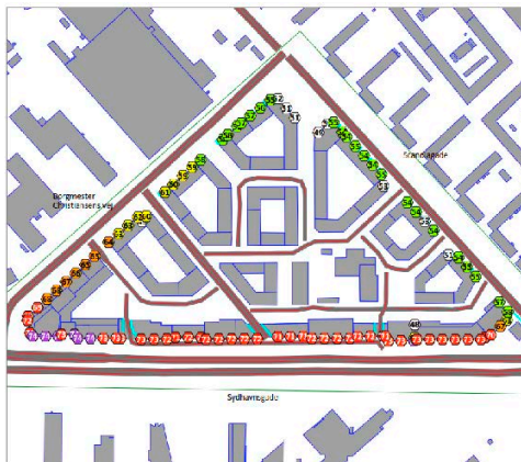
Trafikstøj på facader: Stueetage
