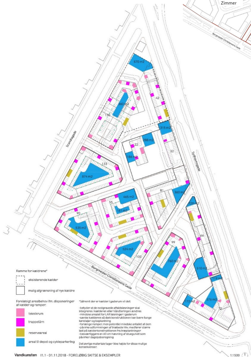
Figur 23 Oversigt over eksempler på parkeringskældere med ramper.
