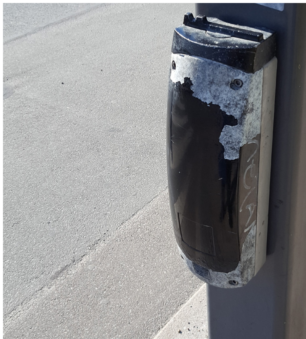
Lydfyr med retningsgiver øverst, der navigerer blinde og svagtseende over krydset i den rigtige retning.
