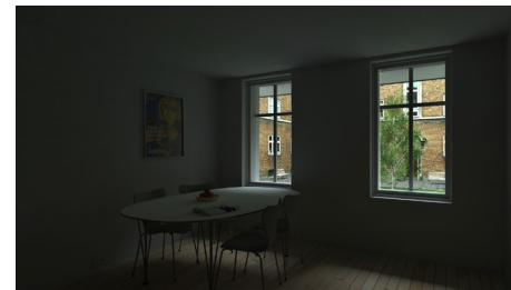
Lyset på en gråvejrsgang med en altan på 1,1 m over begge vinduer
