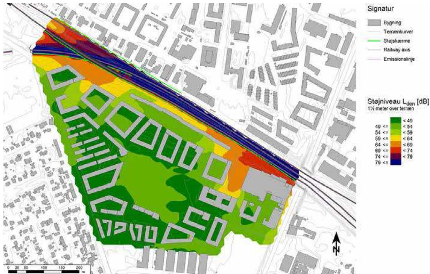
Beregning af fremtidig togtrafikstøj med 2 m høje støjskærme. Illustration: Gade & Mortensen Akustik.
