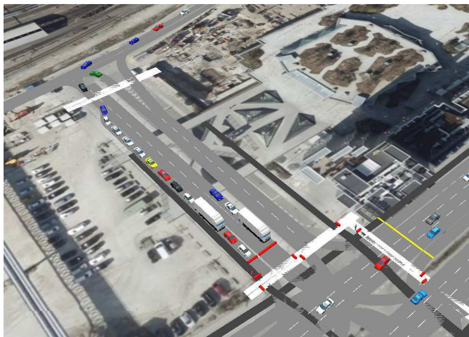
Figur 24 Tilbagestuvning af trafik på Arni Magnussons Gade fra krydset ved Arni Magnussons Gade i eftermiddagsspidstimen.
