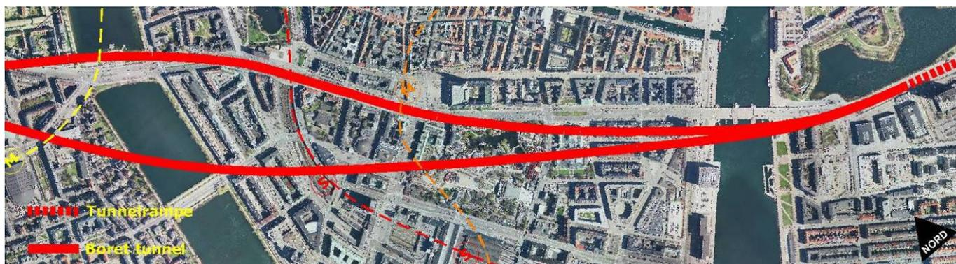
Figur 10: Ideskitse for mulige linjeføringer for en boret tunnel, der forbinder Bispeengbuen og Amager Boulevard. Hvis der skal etableres tilslutning til sidegaderne, skal tunnelen for en del af strækningen følge H C Andersens eksisterende linjeføring.
