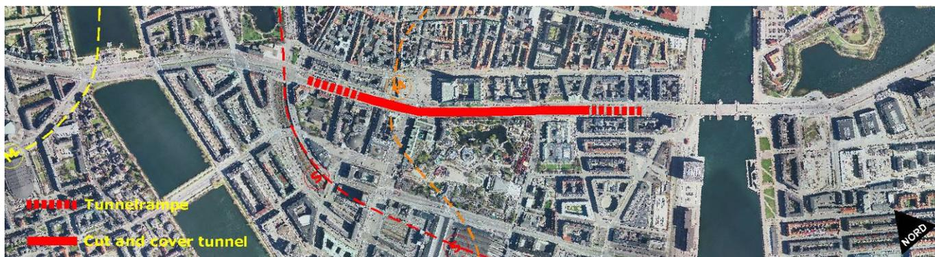
Figur 14: Ideskitse for mulig linjeføring for en "cut and cover" tunnel
