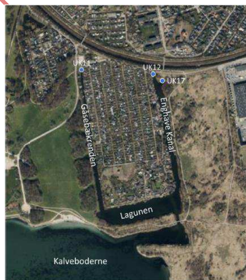
Figur 2. Placering af de 2 eksisterende udløbspunkter; UK11 i Gåsebækrenden og UK12 i Enghave Kanal, samt det fremtidige udløbspunkt UK17 i Enghave Kanal. Rød pil angiver omtrentlig placering af udledningspunktet UK17 i Enghave Kanal.
