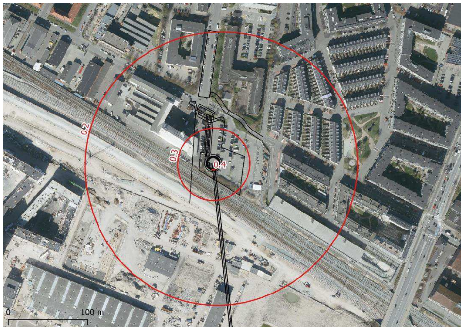
Figur 17.5 Scenarie 1. Grundvandssænkning i toppen af kalken (m), FLSmidth.
