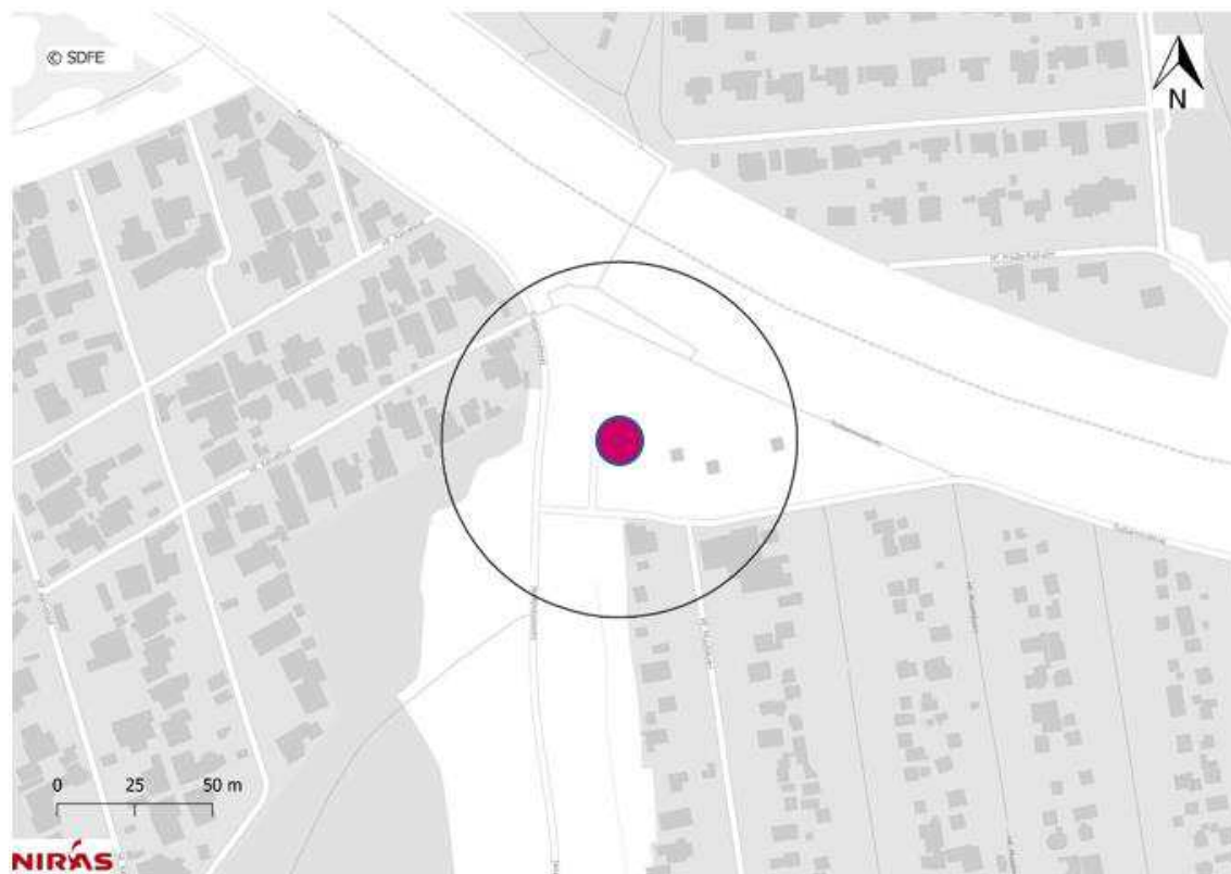
Figur 10.8: Vibrationspåvirkninger fra boring af huller til sekantpæle til skakt ved Musikbyen. Området, hvor der er risiko for vibrationsgener (komfortvibrationer), er markeret med sort streg og ligger i en afstand af op til 50 m fra den vibrationsgivende aktivitet.
