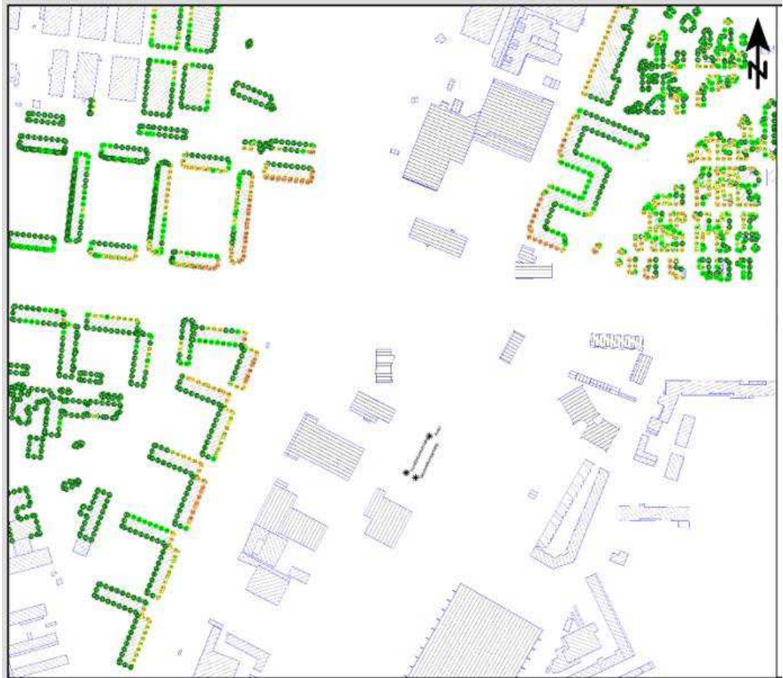
Figur 9.14 Støj på boligfacader fra anlægsarbejder i byggefase 7b for byggepladsen ved Blushøjvej, ved drift af tunnelarbejdspladsen (slurry-metoden) om natten forudsat maksimal støjdæmpning af kran og separationsanlæg.
