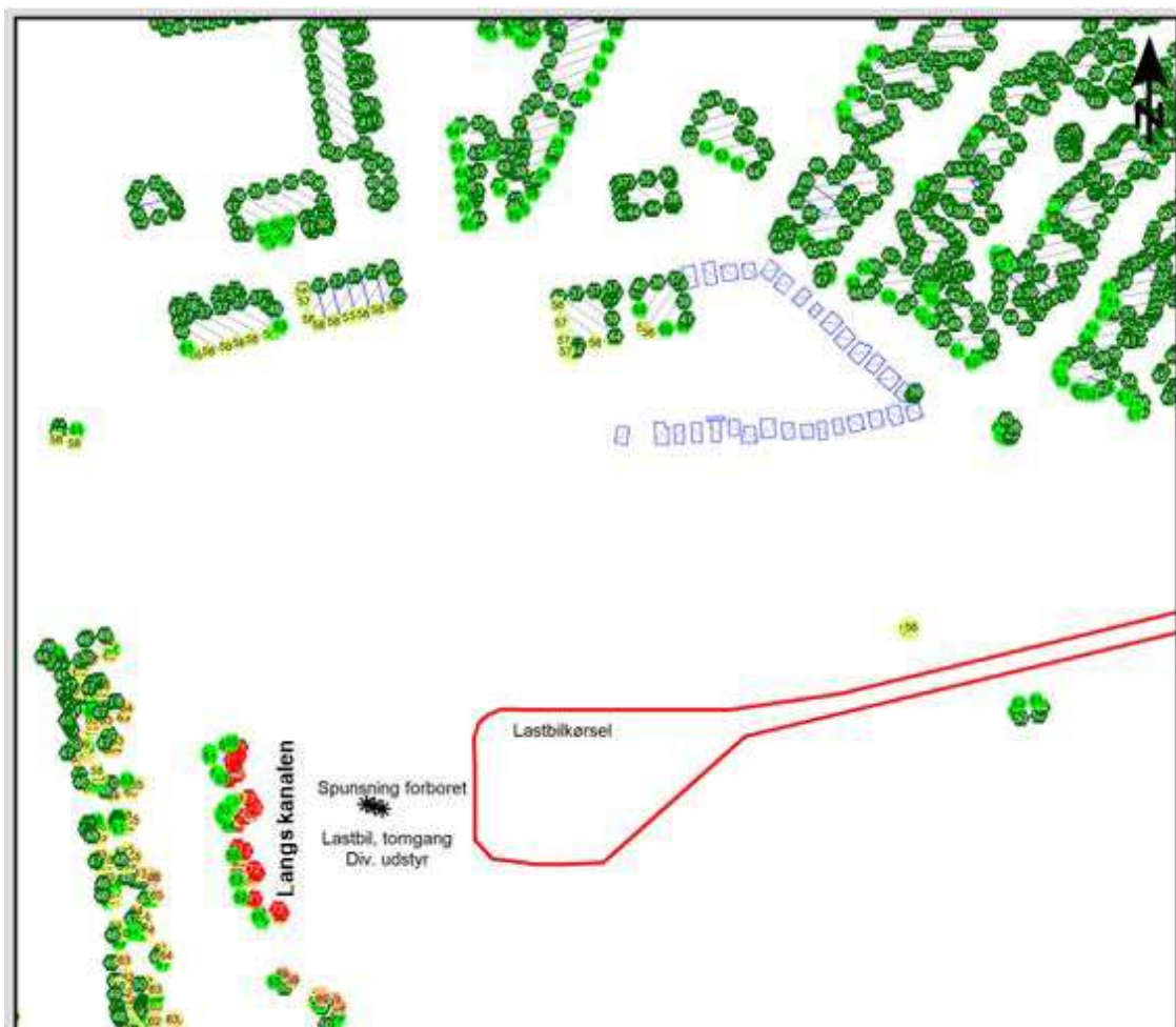
Figur 9.21 Støj fra anlægsarbejder i byggefase 8a for byggepladsen ved Enghave Kanal, hvor der etableres vægge til udløbsbygværk. Støjkortet medtager ikke tillæg for hørbare impulser på 5 dB.
