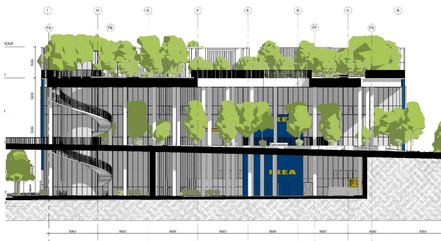
Snit gennem Dybbølsbro, der anskueliggør projektets byrum i tre niveauer, samt det adgangsgivende trappetårn med elevatorer. Illustration: Dorte Mandrup.
