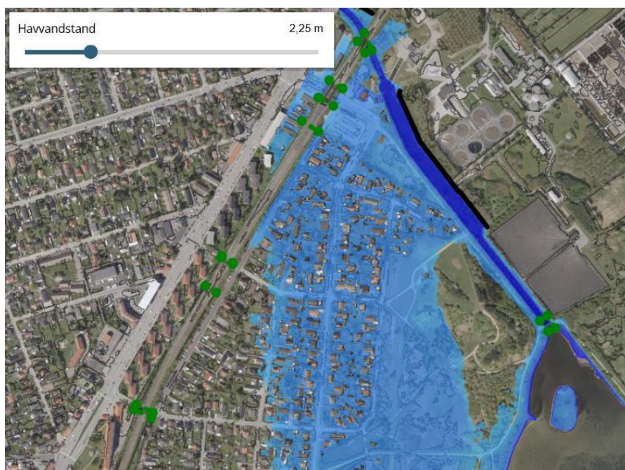
Figur 4 Oversvømmelse ved havvandspejl i kote 2,25 m DVR90 med den ansøgte digeforhøjelse
