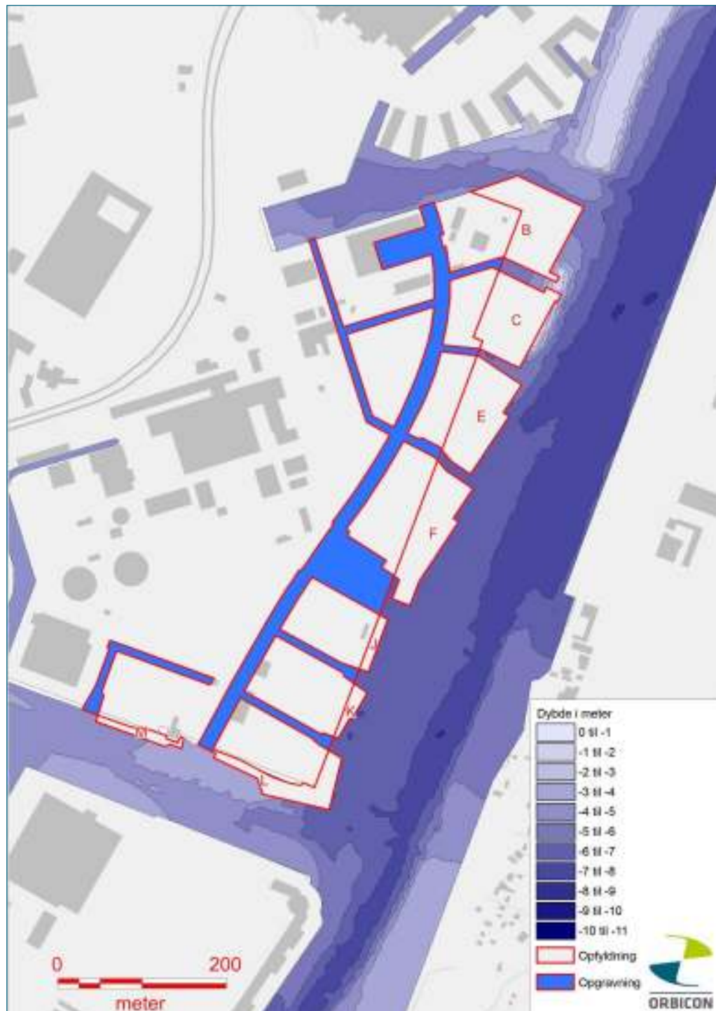
Figur 12.2 Dybdeforhold efter projektets realisering, såfremt der ikke uddybes. Dybde data fra By & Havn, 2014.
