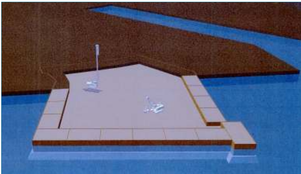
Figur 3.11 Opfyldning er afsluttet og pæleramning påbegyndes. Kilde: NCC, 2013.
