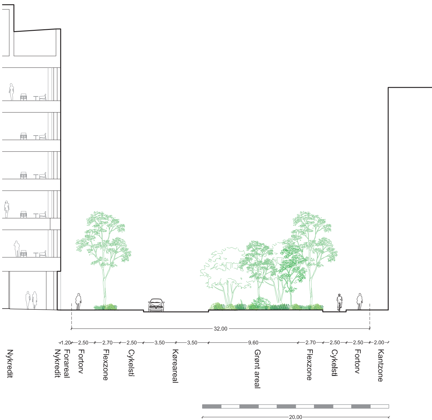
Principsnit af Sundkrogsgade anlagt med 2 spor
