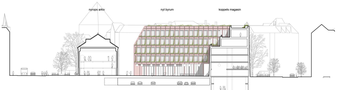
Snit, der viser et eksempel på et nybyggeri i overensstemmelse med tillægget til lokalplan. Nyrops arkivbygning (tv.) er fritliggende. Koppels magasinbygning (th.) er i fire etager. Der kan bygges to etager ovenpå og må etableres tagterrasser mod det indre byrum og øverst. Bebyggelsen har facadebegrønning og plantekasser i facader. På tagfladen etableres en tagterrasse med beplantning og plantebede langs Florsgade og Hjort Lorezens Gade. Der opsættes en støjskærm på 1,5 m mod Hjort Lorezens Gade. Illustration: entasis.
