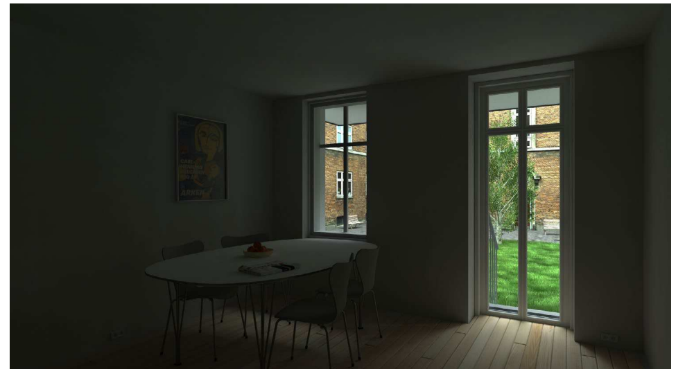
Lyset på en gråvejrsgang med en altan på 1,5 m over begge vinduer og en terrassedør
