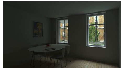
Lyset på en gråvejrsgang med en altan på 1,5 m over det ene vindue
