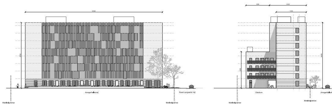
Almene ungdomsboliger – forslag til opstalt af facaden mod øst og Amagerfælledvej samt opstalt af de sydvendte facader. Illustration af Henning Larsen Architects
