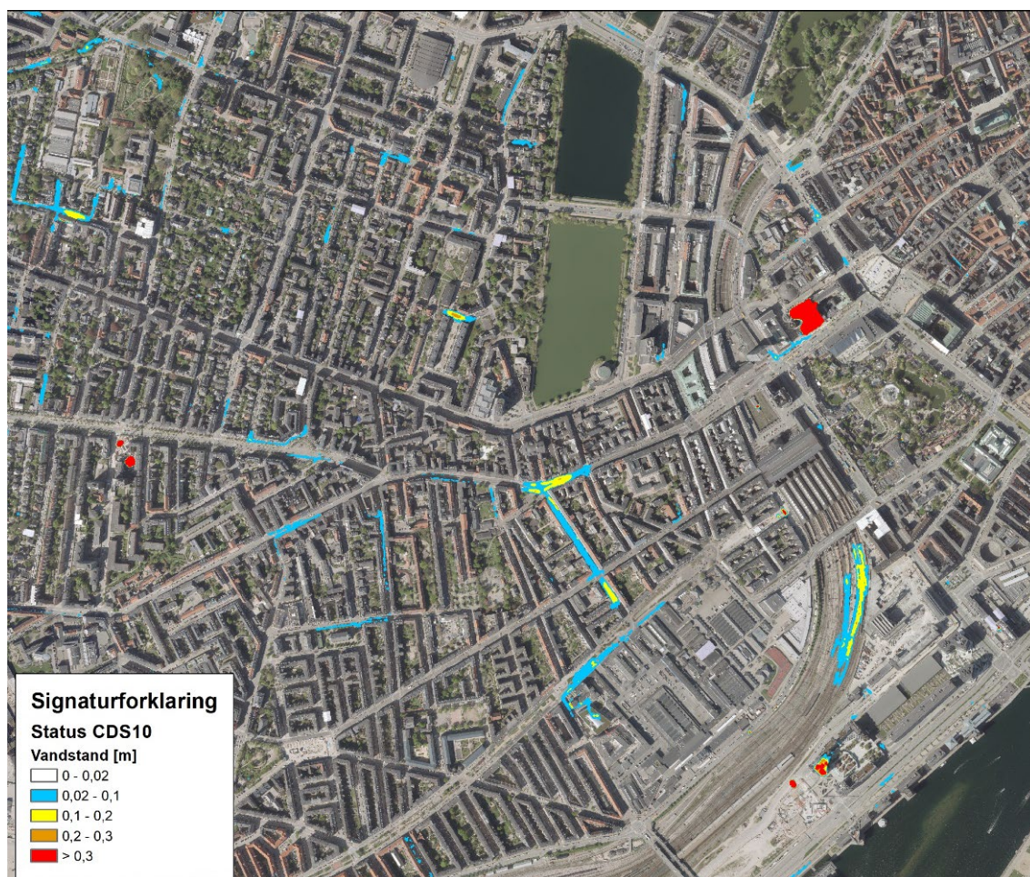
Figur 6.2: Oversvømmede arealer ved en 10-års regnhændelse (CDS) i dagens situation.
