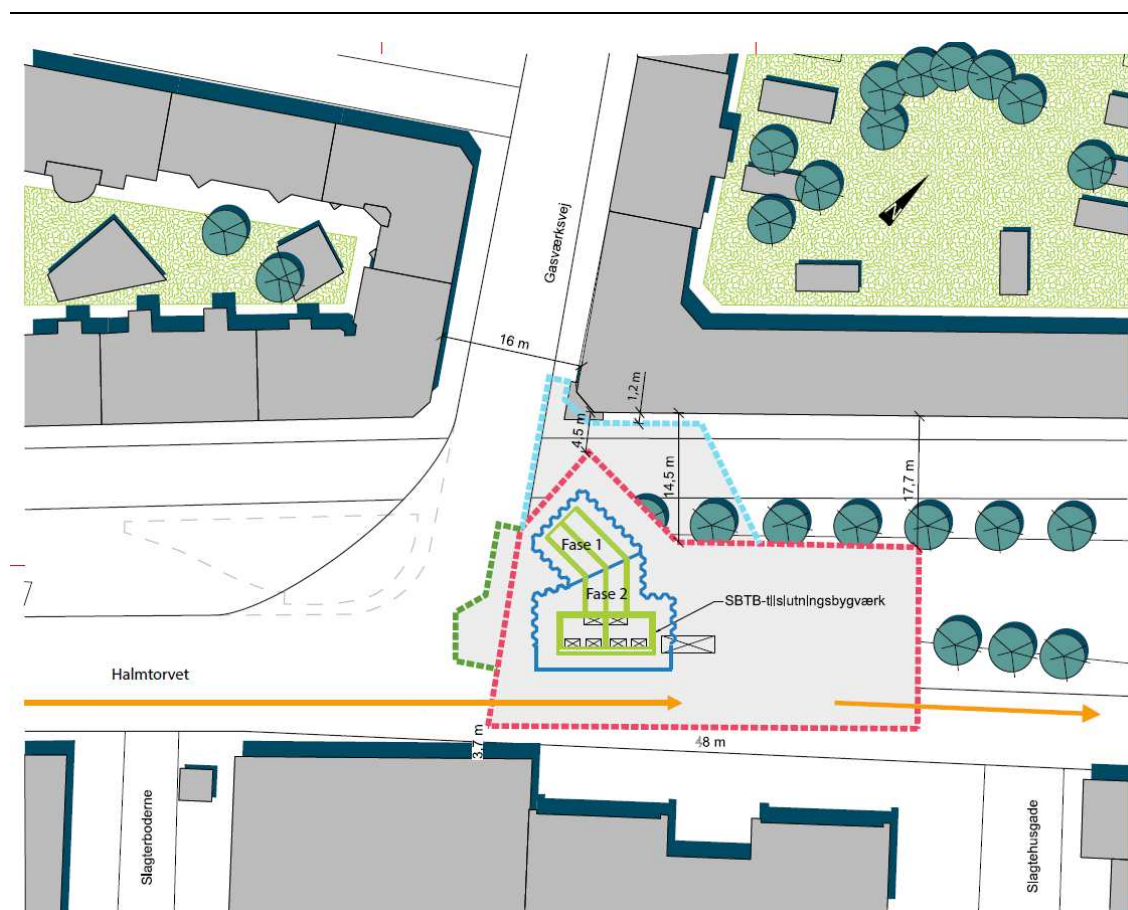
Figur 8.6: Afgrænsning af byggeplads Halmtorvet/Gasværksvej for kommende byggeskakt, fase 1 (etablering af tilslutningsbygværk) Rød linje angiver den overordnede byggepladsafgrænsning i perioden; den grønne stiplede linje en 3 ugers udvidelse; og den blå stiplede linje en 4 ugers udvidelse. . Grøn linje er tilslutningsbygværket, der ligger under jorden og blå er de spunsen rundt om. Potentiel til- og frakørselsvej via Sønder Boulevard for byggeplads trafik vist med fuldt optrukne orange linjer. Midterhellen i Halmtortorvet vest for byggepladsen indskrænkes, så der fortsat er plads til adskillelse af cyklister og fodgængere fra biltrafikken. Nuværende anlæg er vist med stiplede signatur.
