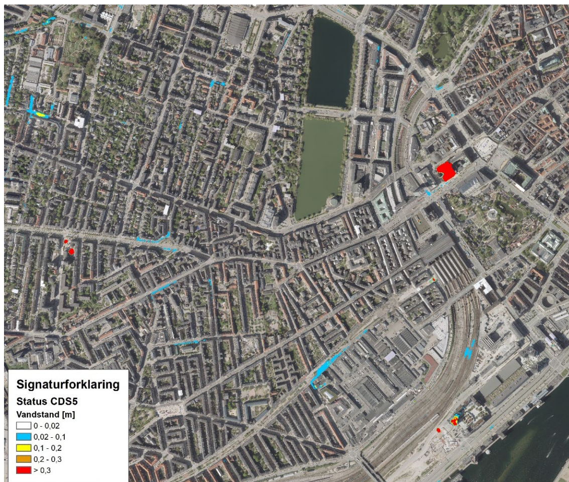
Figur 2.7: Oversvømmede arealer ved en 5-års regnhændelse (CDS5) i dagens situation.
