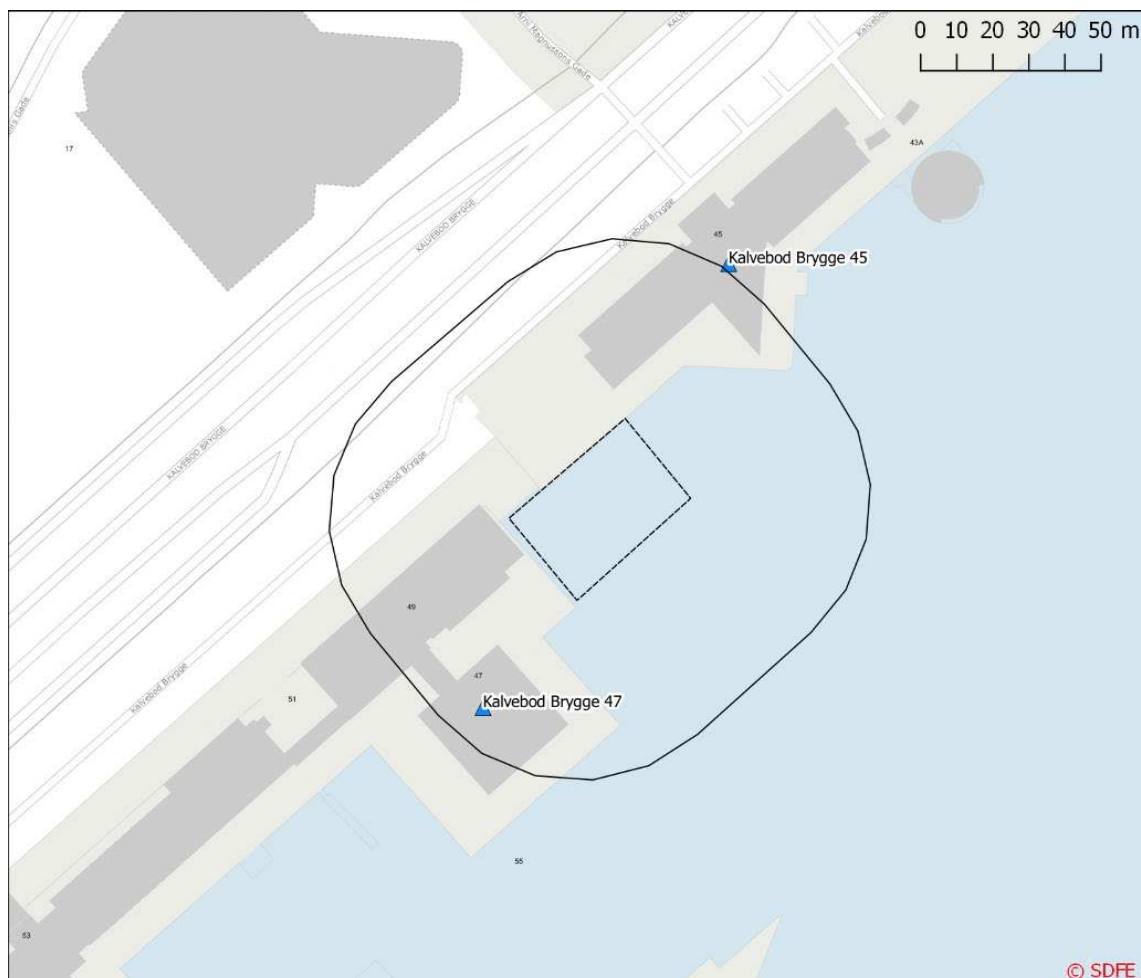
Figur 10.7: Estimerede vibrationspåvirkninger fra silent piling af spuns omkring den midlertidige opfyldning i havnen ved Kalvebod Brygge. Området hvor der er risiko for vibrationsgener er markeret med sort streg og ligger i en afstand af op til 50 m fra den vibrationsgivende aktivitet. Potentiel vibrationsfølsom virksomhed er markeret med blå trekant.
