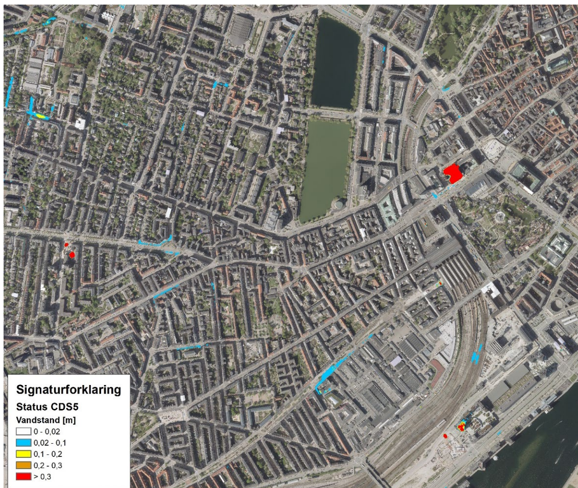
Figur 6.1: Oversvømmede arealer ved en 5-års regnhændelse (CDS) i dagens situation.
