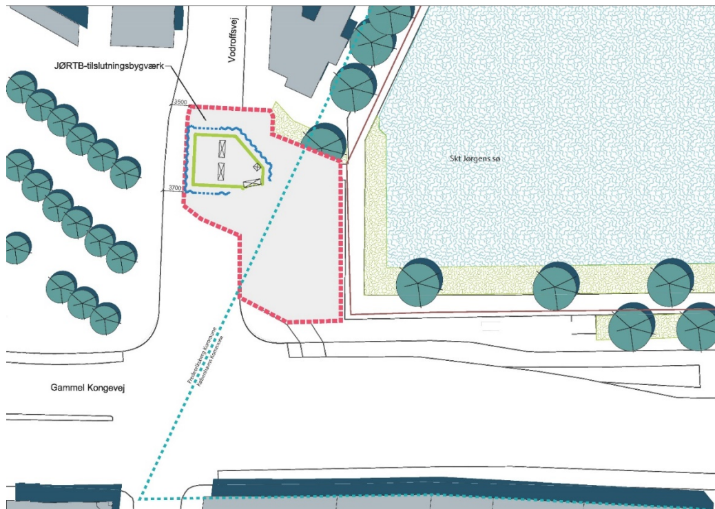
Figur 2.2: Byggepladsen ved Sct. Jørgens Sø i anlægsfase 1, hvor tilslutningsbygværket etableres
