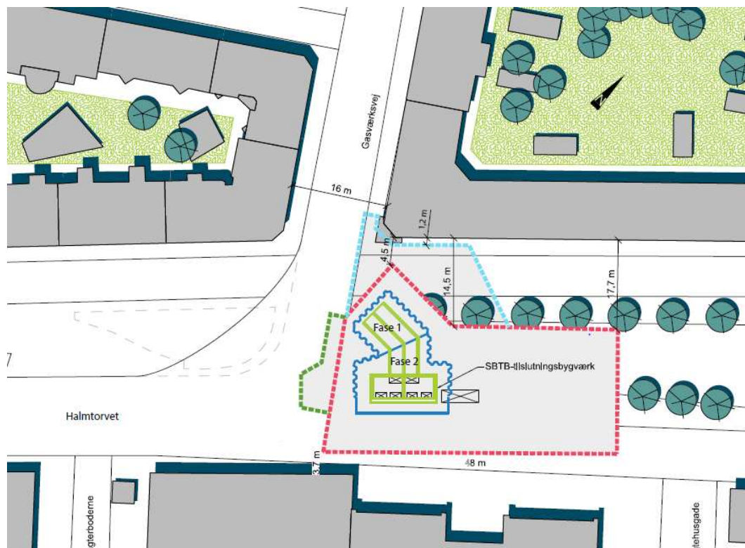
Figur 2.4: Byggepladsen ved Halmtorvet/Gasværksvej i anlægsfase 1, hvor tilslutningsbygværket etableres
