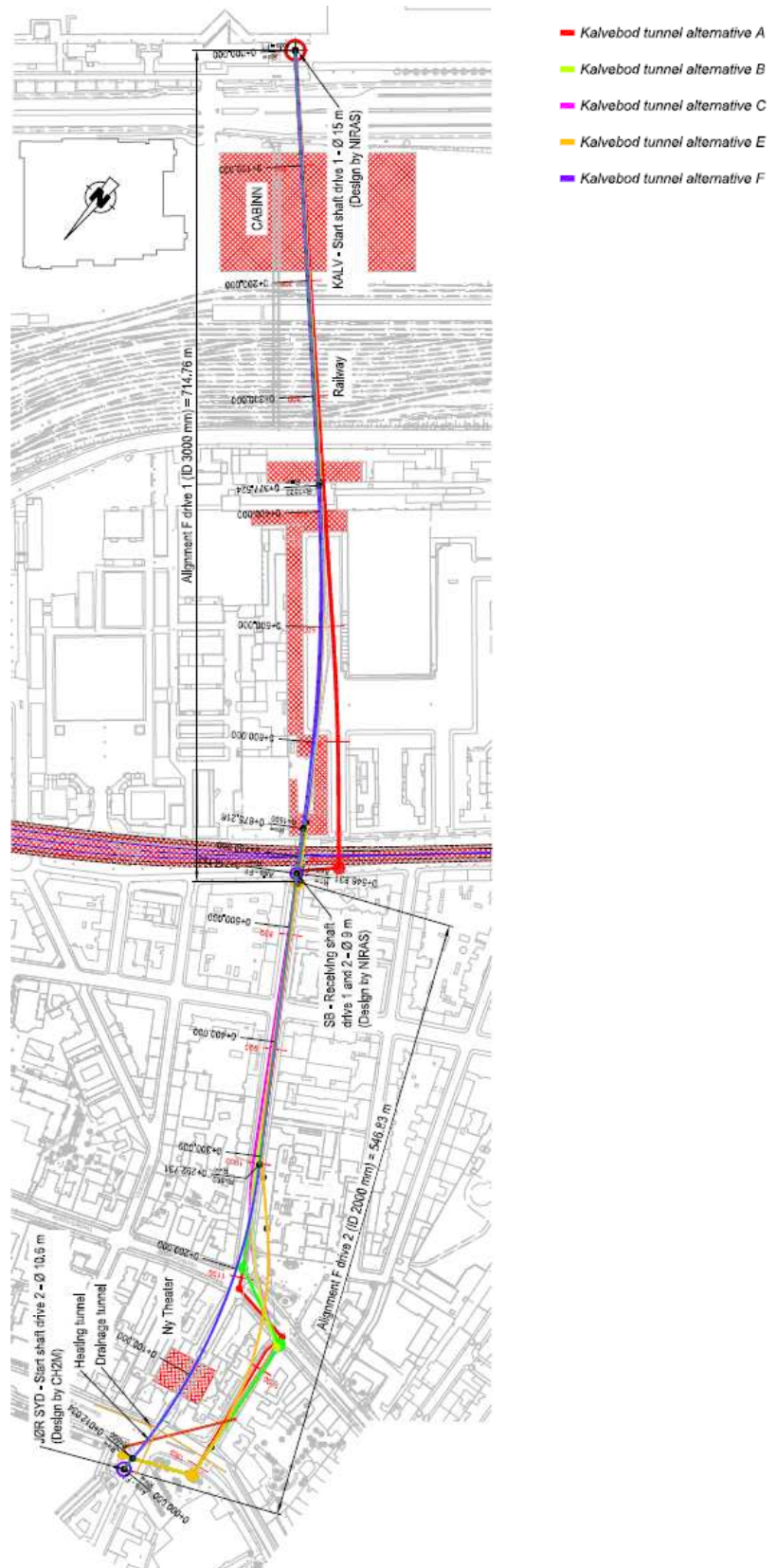
Figur 6.3: Undersøgte linjeføringer for skybrudstunnelen
