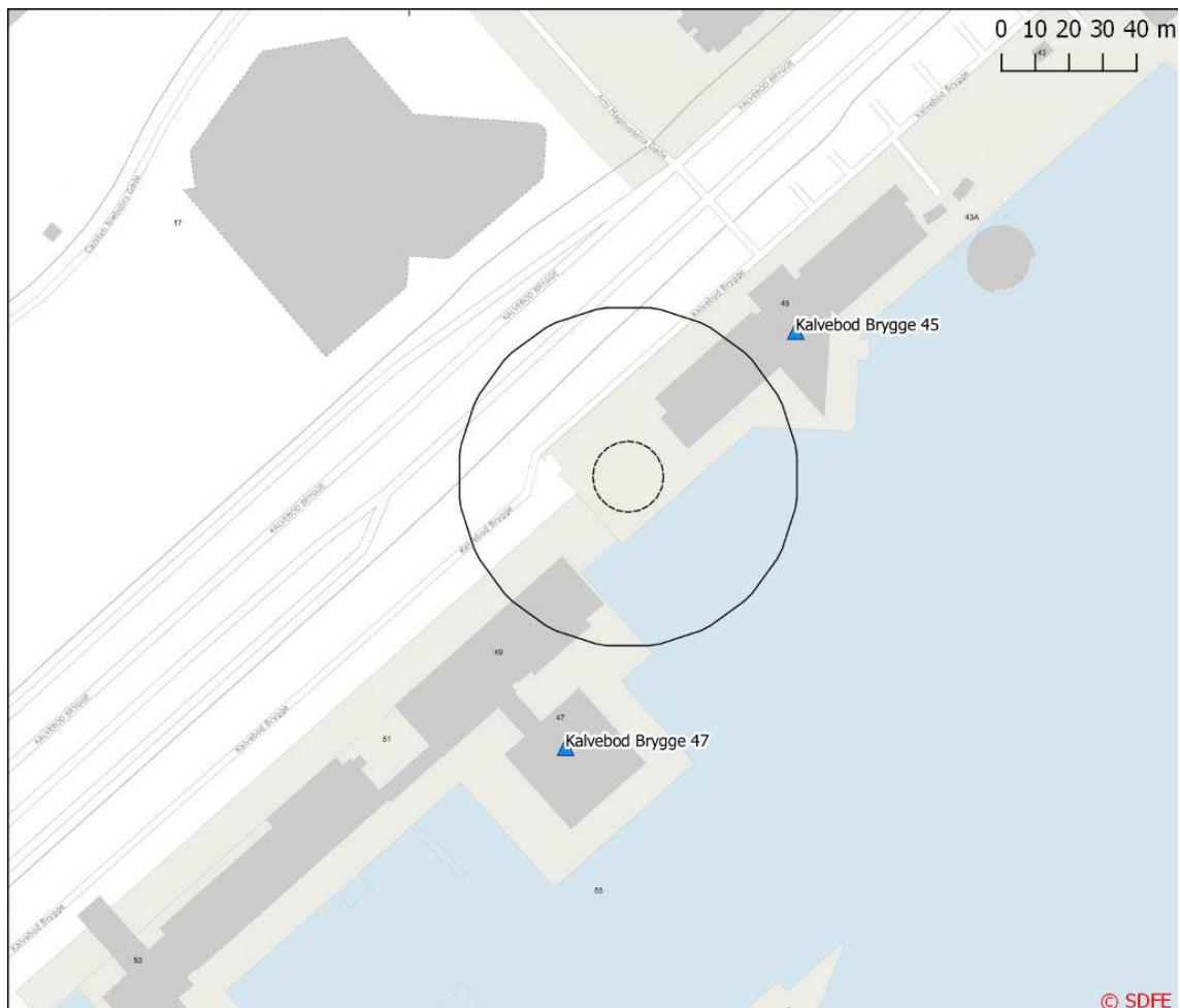
Figur 10.10: Vibrationspåvirkninger fra kapning af opbrydning af kalk ved Kalvebod Brygge. Området hvor der er risiko for vibrationsgener er markeret med sort strek og ligger i en afstand af op til 40 m fra den vibrationsgivende aktivitet. Potentiel vibrationsfølsom virksomhed er markeret med blå trekant.
