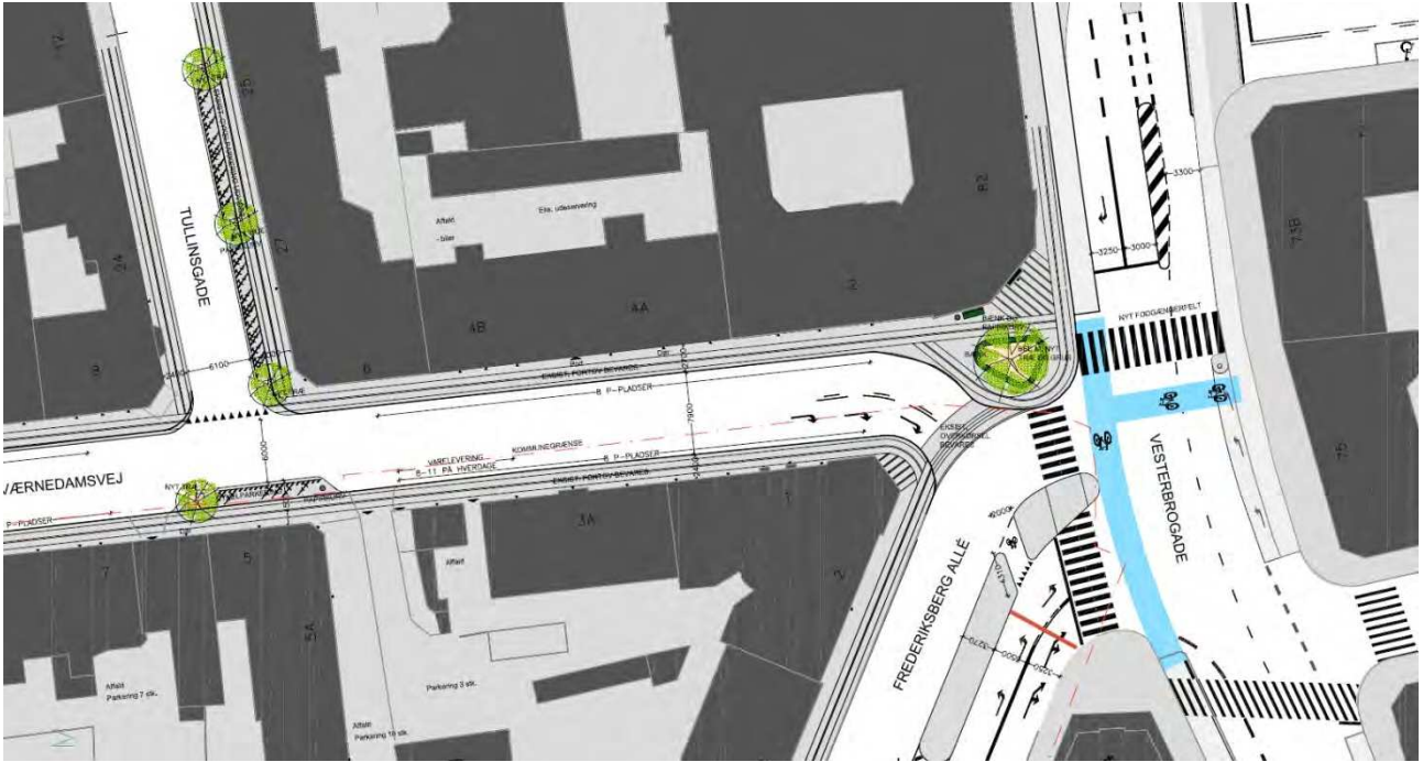
Tilbagetrukket stoplinje på Frederiksberg Allé (vist med rødt)
