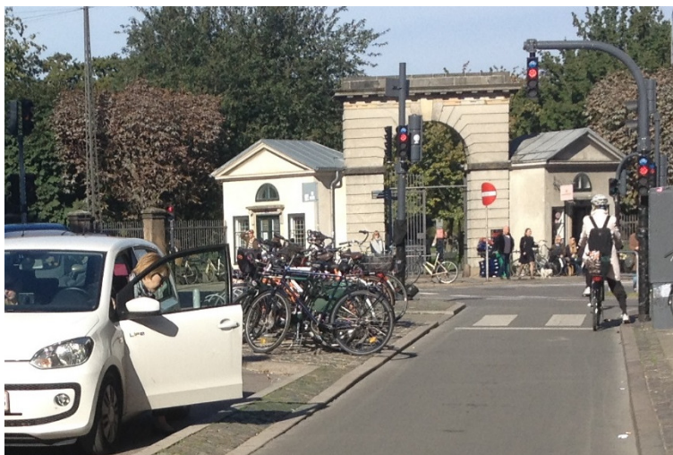
Figur 6 Eksempel på smal helle mellem parkeringsbane og cykelsti
